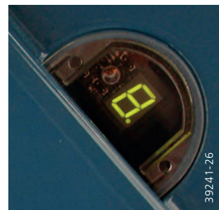
Affichage pour le compteur d'heures de service et les états de fonctionnement
