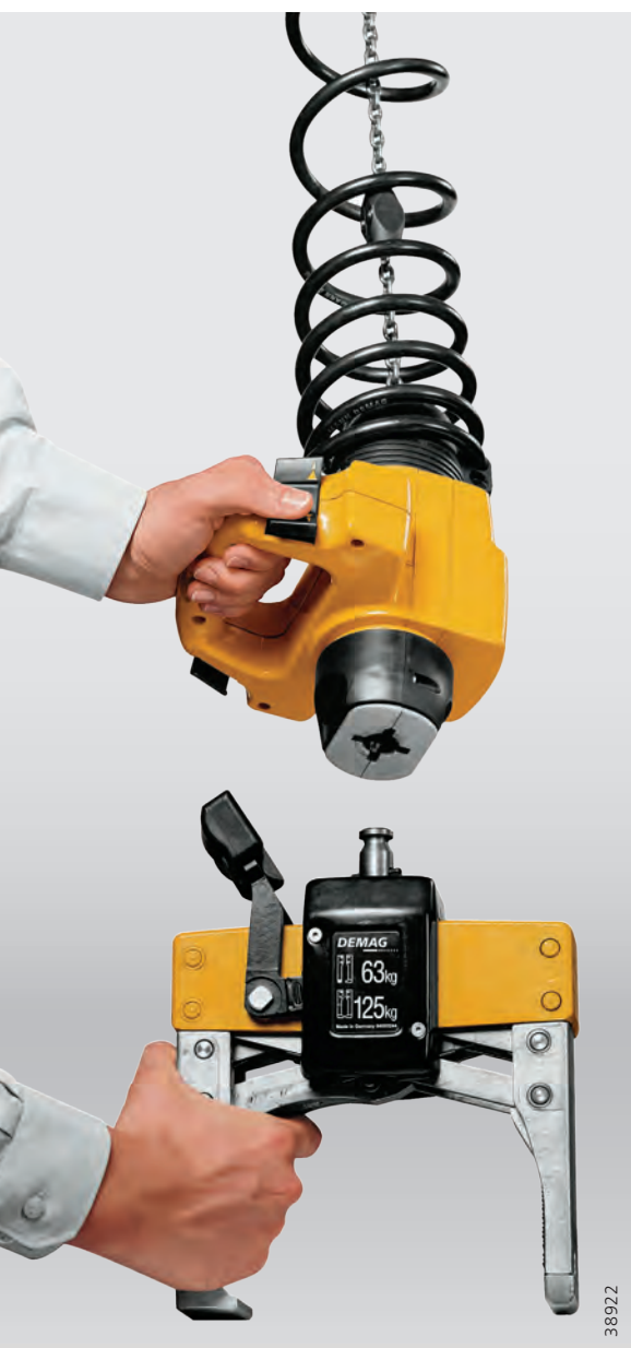
Accouplement à échange rapide utilisé comme interface
