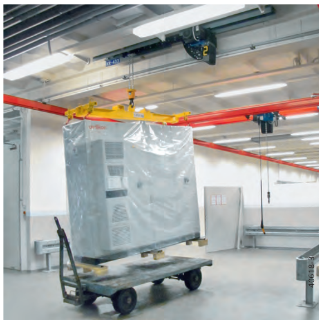
Chariot court KLDC avec course de crochet augmentée (chariot pour applications Big-Bag)
