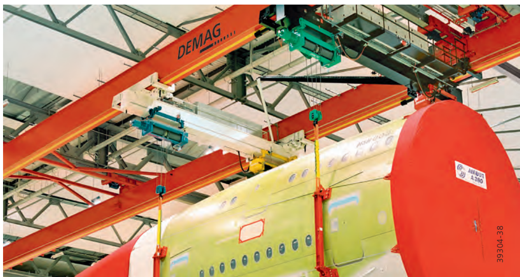
4 mécanismes de levage DH synchronisés pour un transport précis des segments de fuselage
