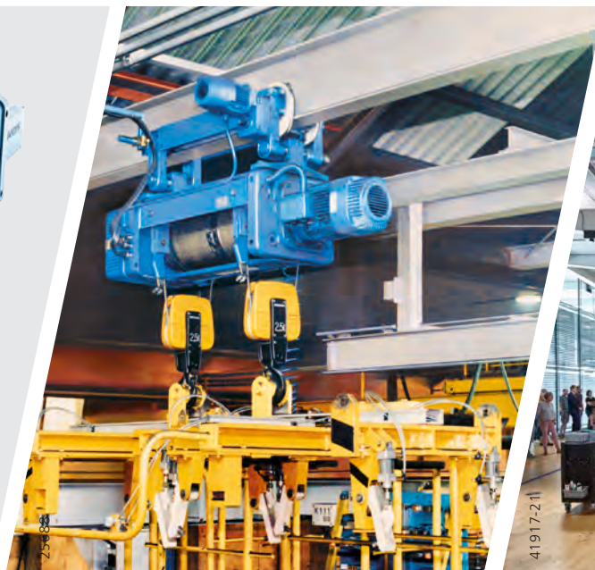
Mécanisme de levage DH avec deux sorties de câble pour le transport de modèles sans déplacement du crochet
