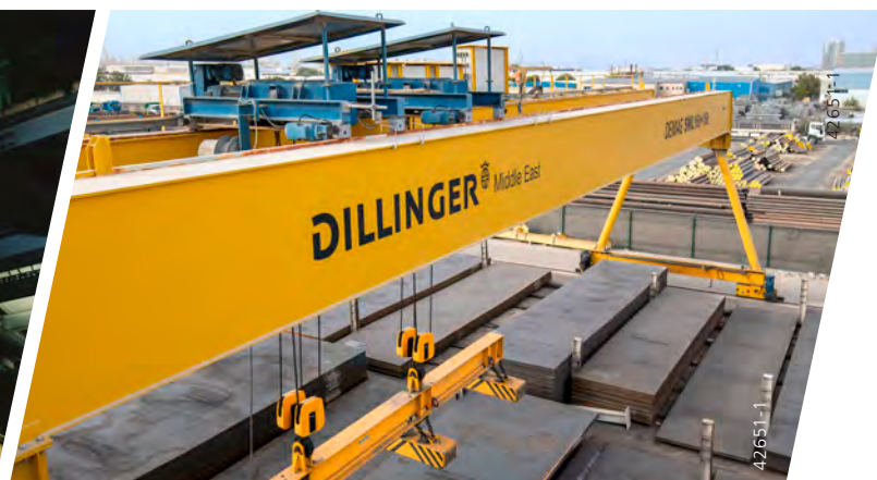
Mécanisme de levage DH en fonderie pour le transport sûr de masses liquides Portique roulant avec mécanismes de levage DH en mode tandem
