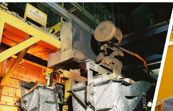
Mécanisme de levage DH en fonderie pour le transport sûr de masses liquides Portique roulant avec mécanismes de levage DH en mode tandem
